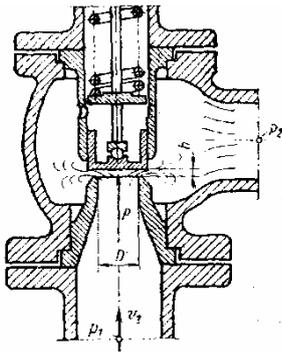
**Задача 2.** Предохранительный клапан диаметром  $D_m$  при открытии  $h_m = 2$  мм пропускает расход масла  $Q_m$  под перепадом давлений  $\Delta p_m = p_1 - p_2 = 1$  МПа. При этом сила давления на клапан  $P_m$ .
