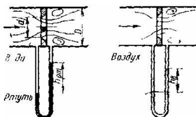
**Задача 2.** Диафрагма размерами  $d = 100$  мм и  $D = 200$  мм, предназначенная для измерения расхода воздуха, тарируется путем испытания на воде. В результате испытаний получено, что минимальный расход воды, начиная с которого коэффициент расхода диафрагмы остается постоянным,  $Q_{\min} = 16$  л/с, и при этом показание ртутного дифманометра, измеряющего перепад давлений на диафрагме,  $h_{\text{рт}} = 45$  мм.
