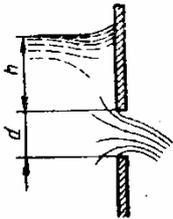
**Задача 1.** Истечение керосина ( $\nu_k = 0,045$  Ст) через отверстие диаметром  $d$  моделируется на воде ( $\nu_m = 0,01$  Ст) при соблюдении вязкостного и гравитационного подобия.
