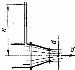
**Задача 1.** При испытании на воде модели насадка, выходной диаметр которого  $d_m = 30$  мм, под статическим напором  $H_m = 50$  м получены расход  $Q_m = 18$  л/с и средняя скорость в сжатом сечении струи  $w_m = 30$  м/с.
