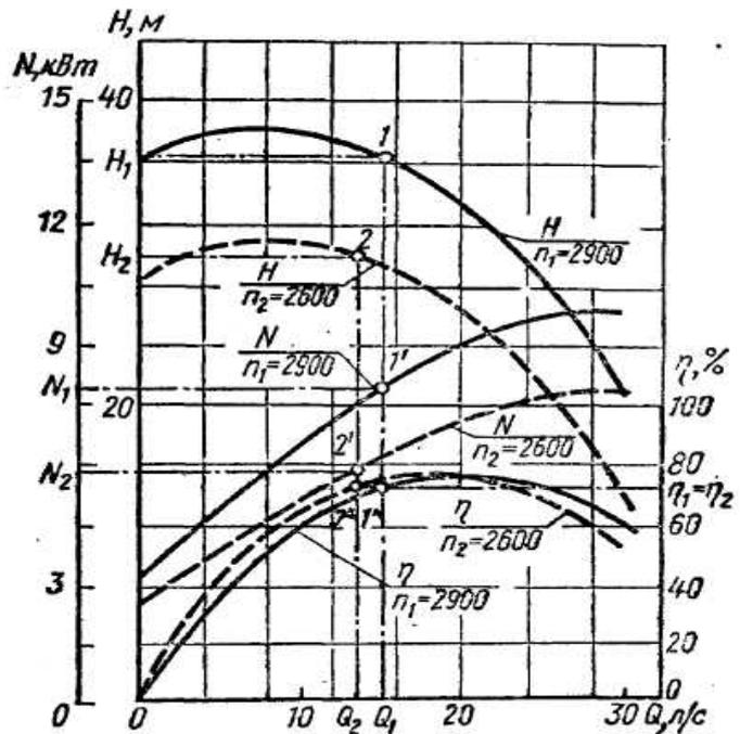
Рис. 4.1. Пересчет характеристики нагнетателя на другую частоту вращения
